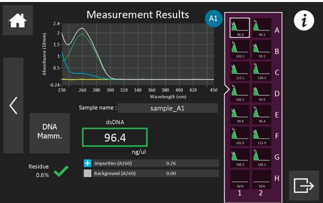
Figure 4: Little Lunaticの結果表示画面。DNA mammalian applicationの結果は、スペクトル形状だけでなく、算出された値も表示される。可能な場合、不純物及び/バックグラウンドの詳細情報が別途表示される。
